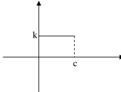
$$F(s) = \int_0^{+\infty} e^{-st} f(t) dt = \int_0^c k e^{-st} dt = \left[ -\frac{k e^{-st}}{s} \right]_0^c = -\frac{k e^{-cs}}{s} + \frac{k}{s} = \frac{k(1 - e^{-cs})}{s}$$
