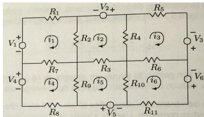
A análise completa de tal circuito requer a determinação dos valores das correntes da malha  $i_k$ , indicados na figura acima, para os valores especificados das fontes de tensão e dos resistores. É necessário, então, formular um sistema de equações lineares simultâneas com as quantidades  $i_k$  como incógnitas. Cada uma das equações de tal sistema linear é determinada pela aplicação da lei de Kirchoff em torno das malhas. Por exemplo, para a malha definida pela corrente  $i_1$ , temos:
