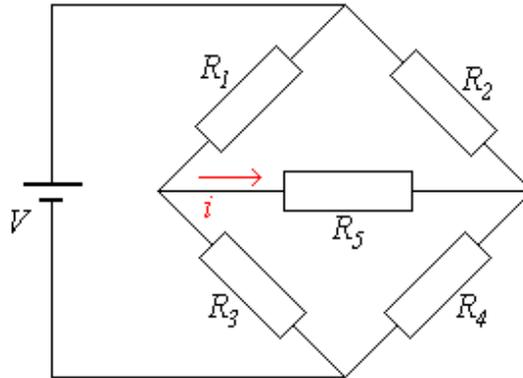
Este circuito, chamado de *Ponte de Wheatstone*, é usado para *medições precisas de resistência*. Aqui,  $R_4$  é **uma resistência desconhecida** e  $R_1, R_2$  e  $R_3$  são resistores ajustáveis (potenciômetros).  $R_5$  representa um galvanômetro (aparelho que mede corrente). Depois de variar as resistências  $R_1, R_2$  e  $R_3$ , até que a leitura do galvanômetro acuse **zero**, a fórmula  $R_4 = \frac{R_2 R_3}{R_1}$  determina a resistência desconhecida  $R_4$ .
