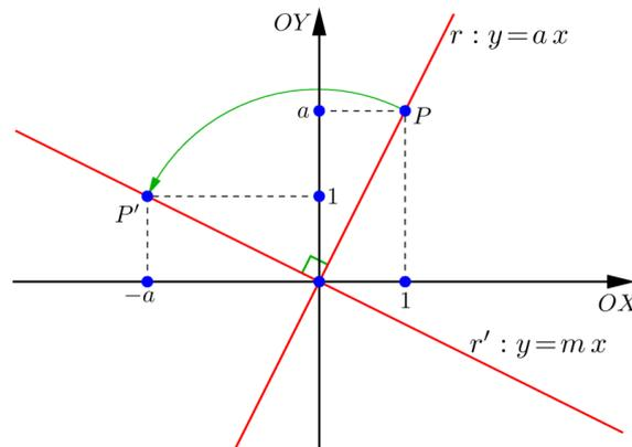
Fig. 15: Retas perpendiculares que se intersectam na origem.
